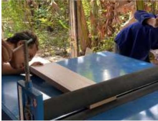
**Gambar 4.** Pengoperasian mesin pelapis HPL
