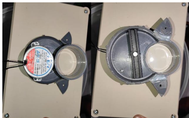
Gambar 5. Perancangan mekanis pendorong pakan ikan
