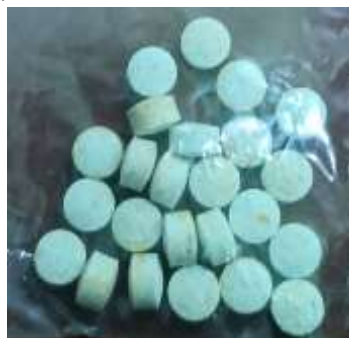
Gambar 5. Tablet ferro sulfat berbahan dasar ferro sulfat dari scrap besi bengkel bubut.
