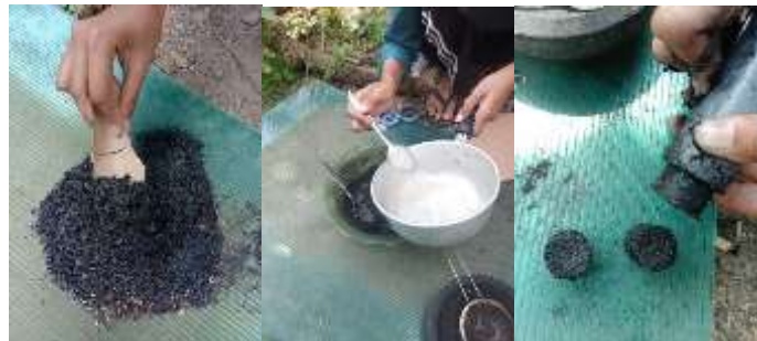
Gambar 5 Proses pembuatan briket bioarang dari limbah sekam padi
