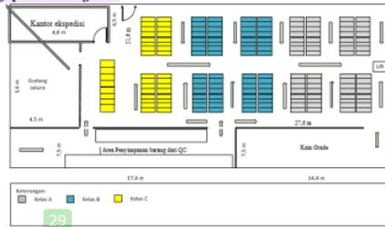
Gambar 2 upaya perbaikan tata letak dengan metode *class-based storage*
